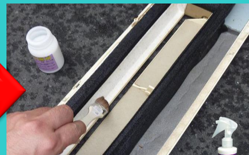
フラップ内側を カビ守護神コーティング剤で防カビ処理
